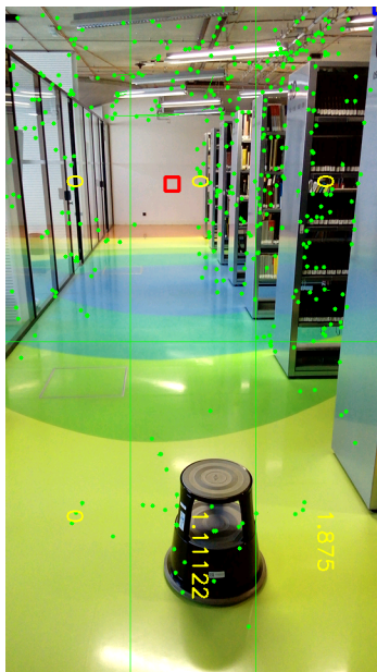
OBRÁZEK 3.15: Obrazovka při testování, čísla u jednotlivých segmentů znaemeají průměrný okamžik kontaktu pro daný segment
