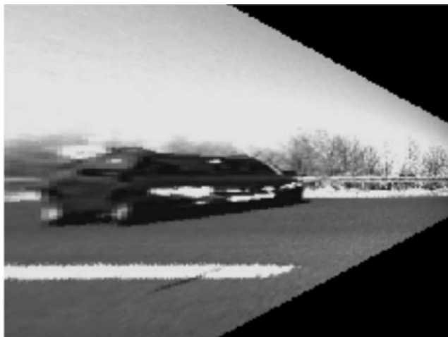
OBRÁZEK 2.8: Příklad přepočteného obrazu pomocí inverzní perspektivy [23]
