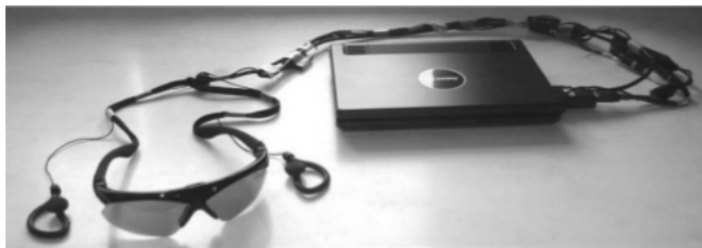
OBRÁZEK 2.1: Implementace systému vOICe - "vidět zvuk", brýle s integrovanou kamerou, sluchátka, počítač [18].
