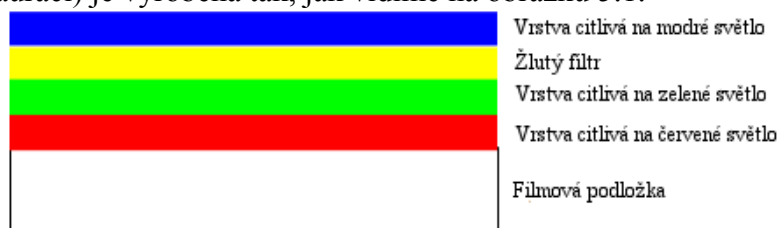
obrázek 5.1: Zobrazení barevných vrstev na filmu
