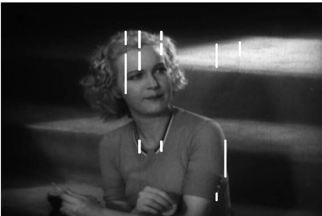
Obrázek 12.26: Rozšíření detekce z obrázku 12.25 tak, aby došlo k odstranění celé skvrnové chyby
