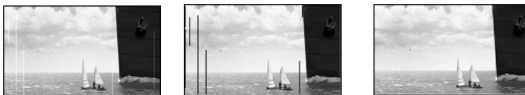
obrázek 6.8: Odstranění škrábnutí z filmové sekvence „Titanic“: (a) originální obrázek, (b) detekované škrábnutí, (c) opravený obrázek [2]
