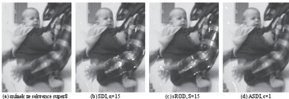
obrázek 3.3: Detekce skvrnových chyb v sekvenci super8 ; (a) originální snímek; (b) SDI detekce s prahem \alpha=15 ; (c) sROD detekce s prahem S=15 (d) adaptivní metoda s prahem \epsilon=1 [1]
