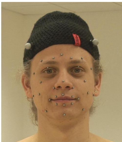
Obrázek 11: Umístění markerů na snímané osobě (modelu)
