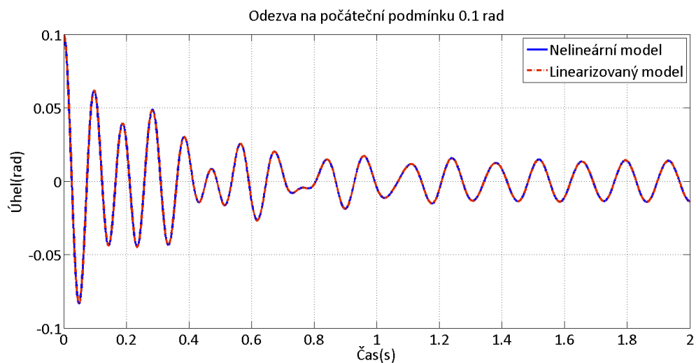
Obrázek 26. Odezva nelineárního a linearizovaného systému pro počáteční podmínku \beta_0 = 0.1 rad
