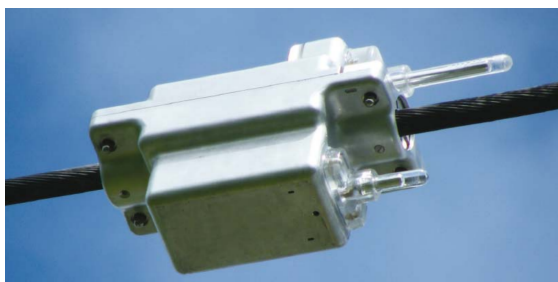
Obr. 20 – Měření teploty z údajů o průhybu vodiče, obchodní název Ampacimon [24]
