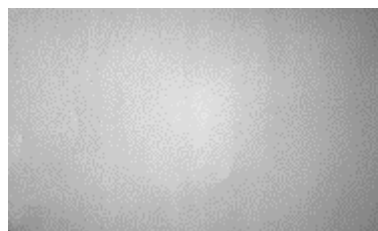
Obr. 19 - Efekt vinětace na obrázku sejmutém senzorem MT9V034 (zmenšeno)
