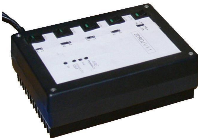
Obr. 26 Konstrukční uspořádání a návrh čelního panelu napájecího zdroje
