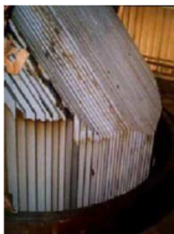
Obr. 10 Narušení chemických vazeb v oleji způsobených narušením izolace mezi jádrem a nádobou, zdroj [6]
