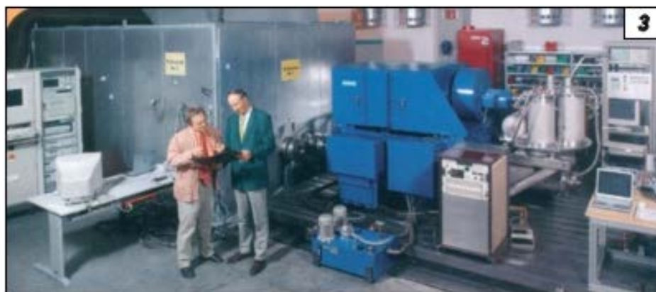
Obr. 9: Supravodivý generátor firmy Siemens o výkonu 4 MW [15]
