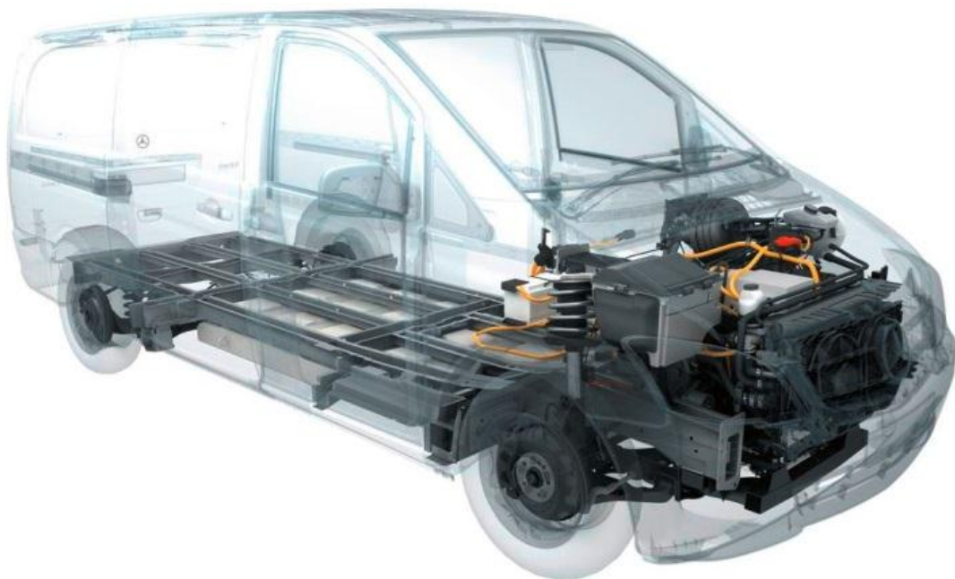
Obrázek 22 Průřez dodávkou Mercedes-Benz Vito E-CELL [37]
