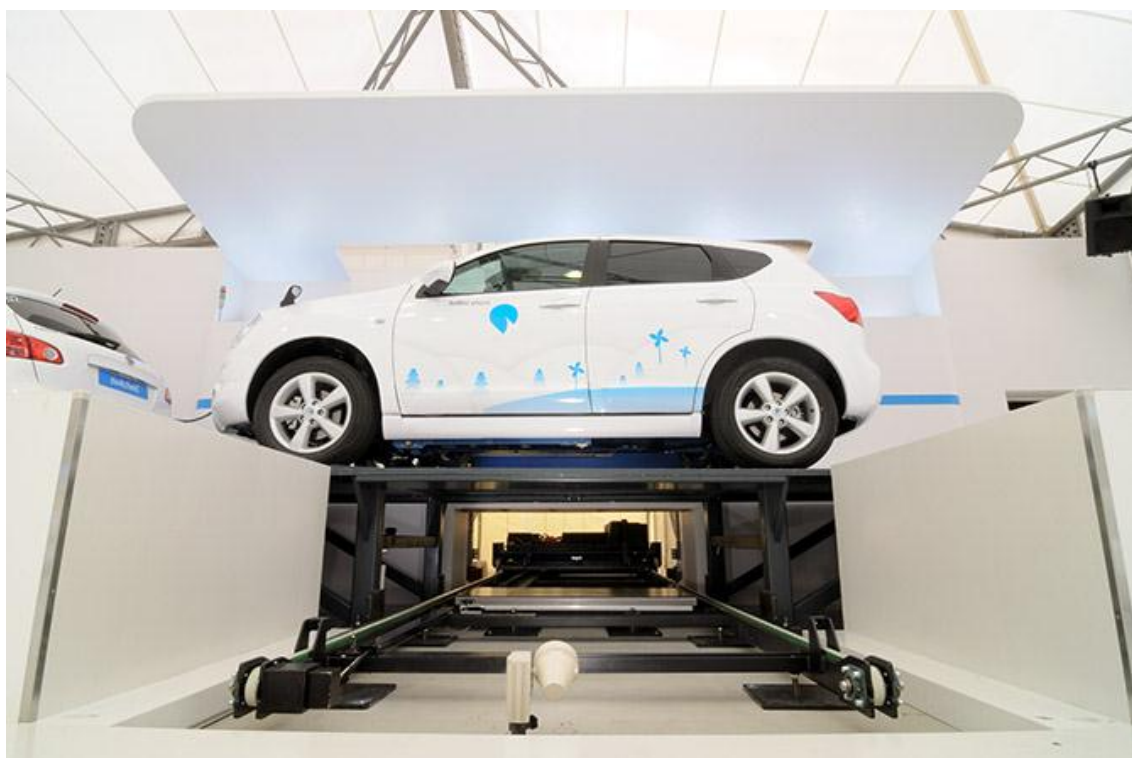
Obrázek 6 Ukázka automatizované výměny baterií v elektromobilu [23]
