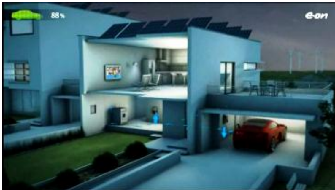
Obrázek 7 Ukázka využití elektrické energie v elektromobilu pro pokrytí spotřeby rodinného domu [24]
