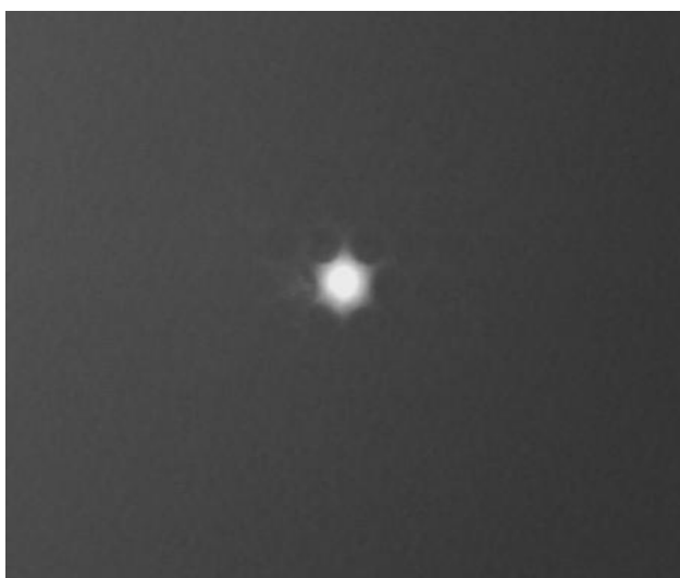
Obr. 46 Správně změřená stopa pole mikrostrukturního vlákna ESM-12B
