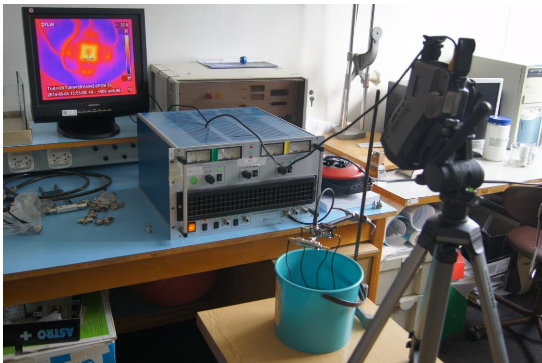
Obr. 7.4 – Průběh měření veličiny SAR celé matice pomocí IR kamery FLIR P25.
