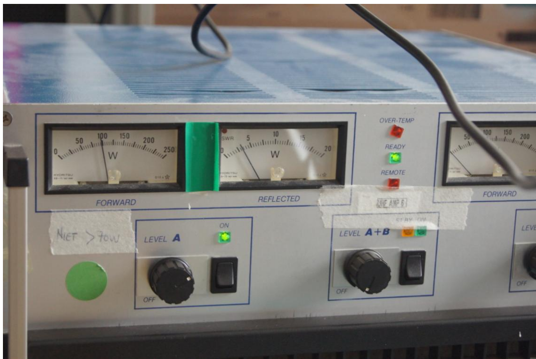
Obr. 7.6 – Pohled na přístroje udávající výkon dodávaný generátorem i výkon odražený.
