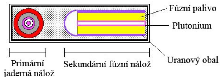
Obr. 12: Řez termojadernou zbraní typu Teller-Ulam.[21]
