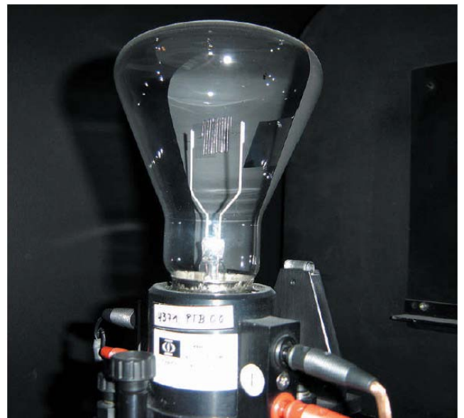
Obrázek 27 - Normál svítivosti s maskováním v kalibrované objímce PRC Krochmann
