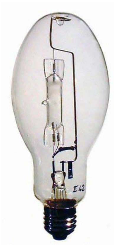
Obrázek 29 – Normál světelného toku užívaný v Tesle Holešovice (čirá vysokotlaká rtuťová výbojka)
