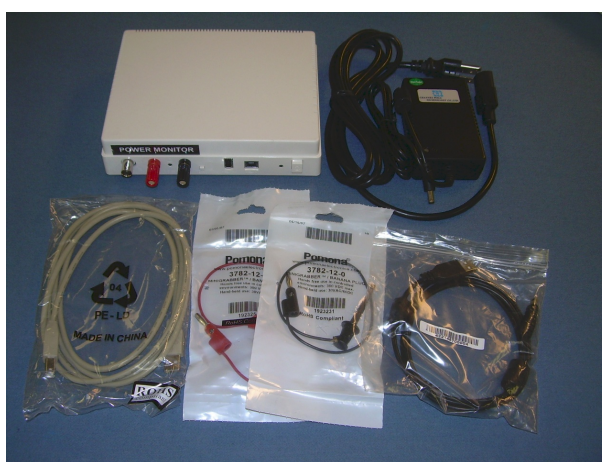
Obr. 8 Měřicí zařízení připojené k počítači přes USB port
