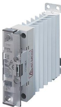
Obr. 42 - Příklad externího SSR
