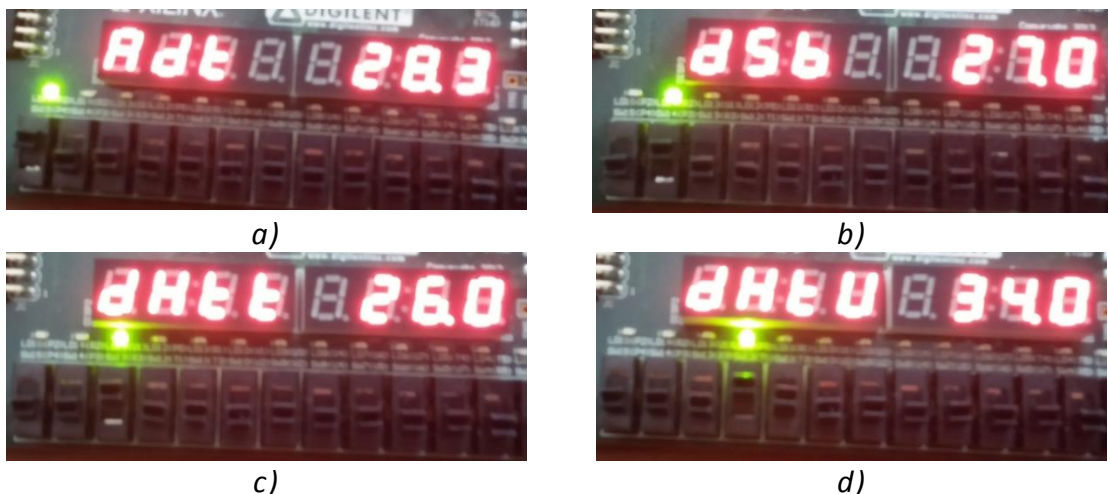
Obrázek 7.2.2- Hodnoty z různých čidel a) teplota z ADT7420 b)teplota z DS18B20 c)teplota z DHT11 d)relativní vlhkost z DHT11
