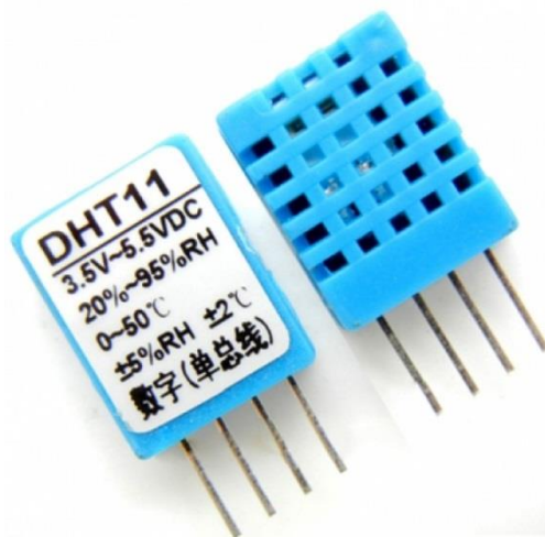
Obrázek 5.3.1 – Podoba krytu čidla DHT11 [7]
