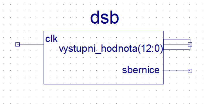
Obrázek 7.5.1 - Komponenta pro řízení čidla DS18B20
