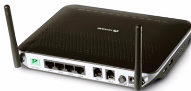
Obrázek 5.4: ONT jednotka Huawei HG8245 - Zdroj [15]
