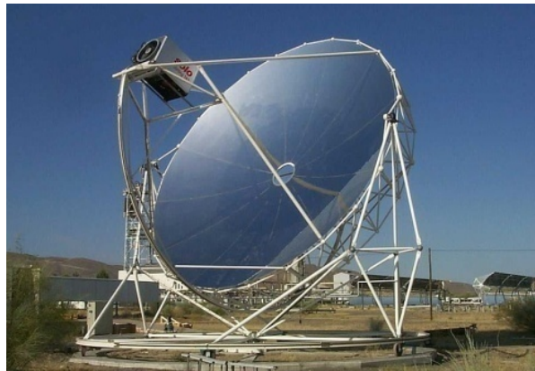
Obr. č. 5: Zkušební solární jednotka EuroDish se Stirlingovým motorem [W3]
