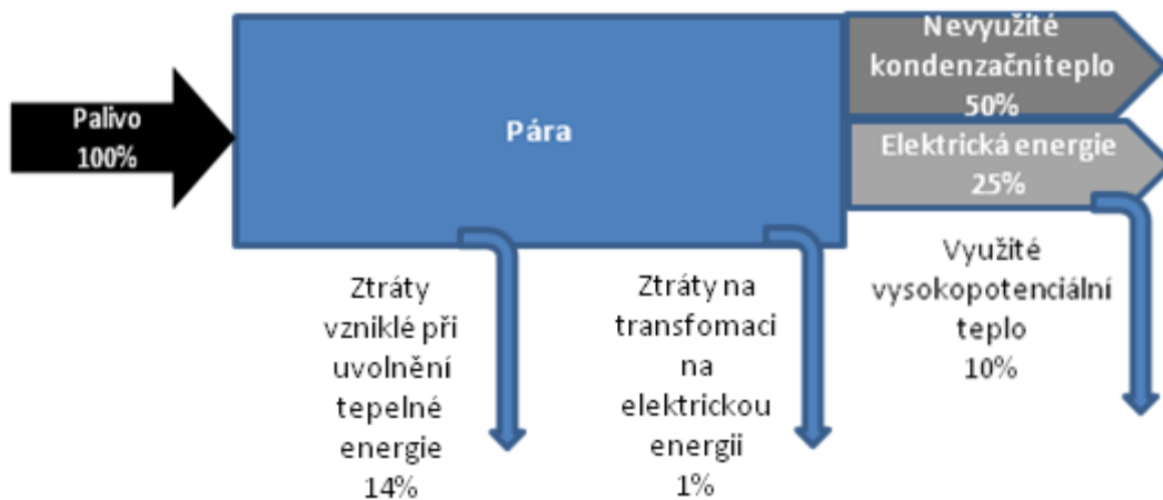
Obrázek 4: Schéma KJ s kondenzační parní turbínou
