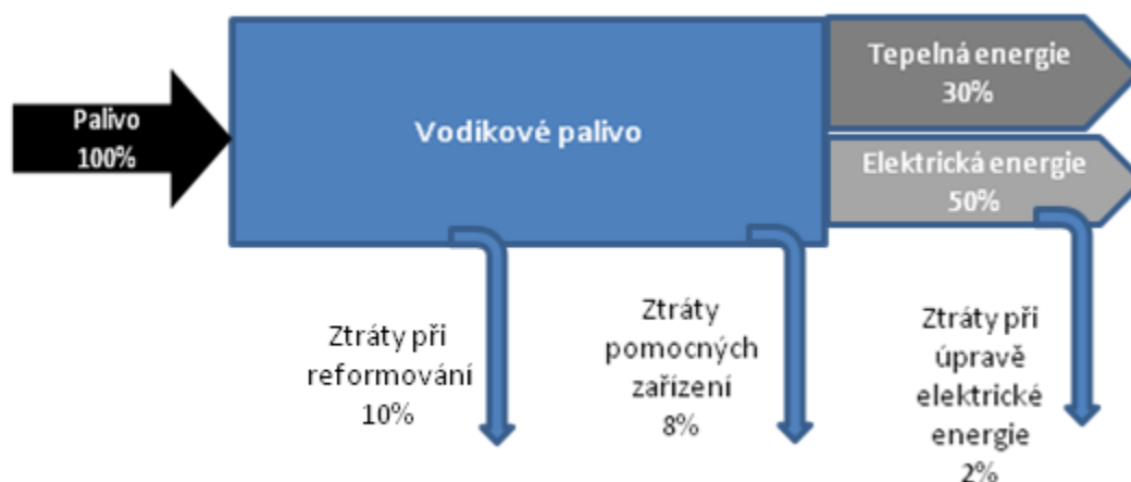
Obrázek 2: Schéma KJ s palivovým článkem
