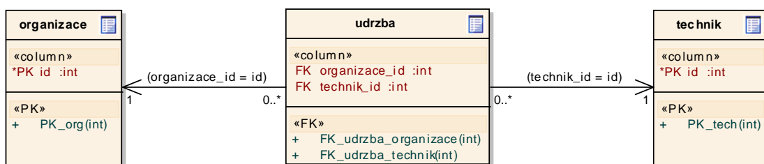
Obrázek 3.3. Příklad vymodelovaného databázového vztahu kardinality M:N s pomocnou tabulkou.
