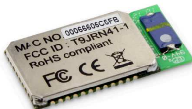
Obr. 10 Bluetooth modul RN41 od společnosti Roving Networks Chyba! Nenalezen zdroj odkazů.
