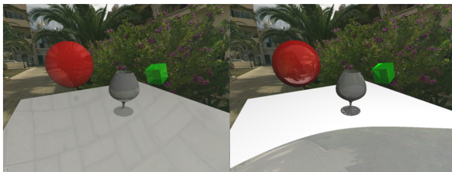
Obrázek 6.6: Láme-li se paprsek pouze při protnutí přední stěny (vlevo) a při protnutí přední i zadní stěny objektu (vpravo).
