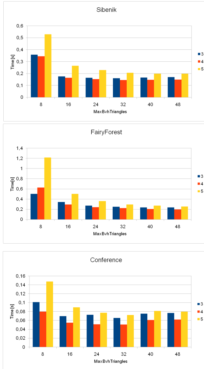
Obrázek 6.4: Výpočet stínů. Závislost času na maximálním počtu trojúhelníku v listě BVH pro různé hloubky SPH.
