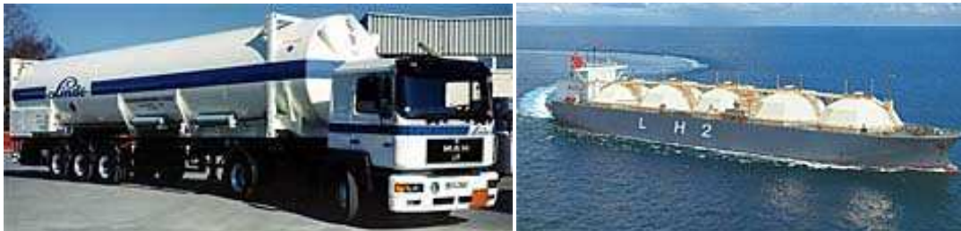
Obr. 27 Přeprava plynného vodíku kamiómem a kapalného vodíku lodí [11]
