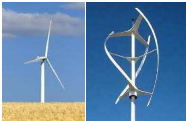
Obr. 18 VtE s vodorovnou osou (vlevo) a vertikální osou [14]
