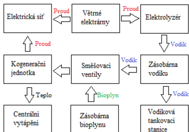
Obr. 1 Schéma VtE s vodíkovou akumulací v Německu [1]
