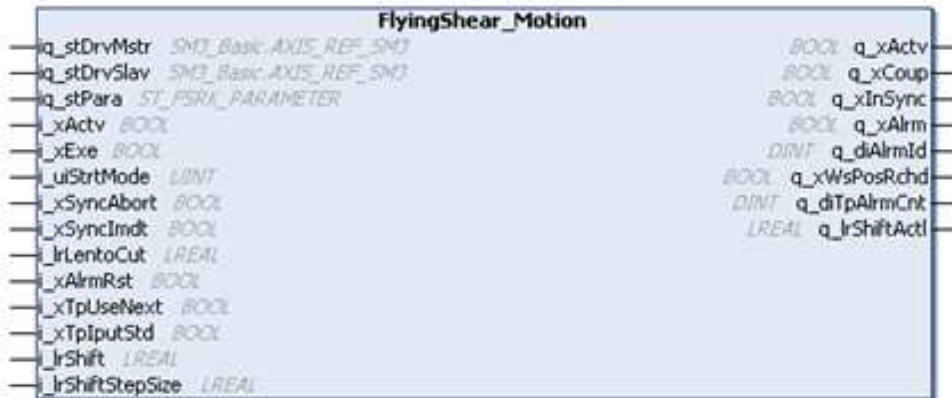
Obrázek 5.1: Pin diagram funkčního bloku FlyingShears Motion z knihovny Packaging.[15]
