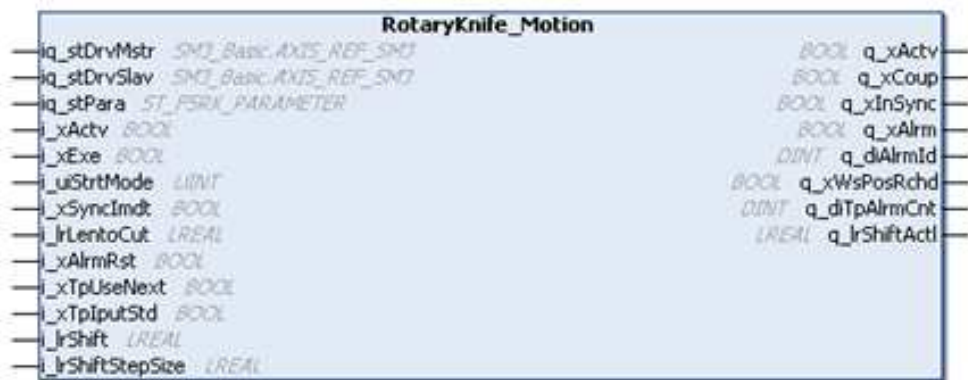
Obrázek 5.2: Pin diagram funkčního bloku RotaryKnife Motion z knihovny Packaging.[15]
