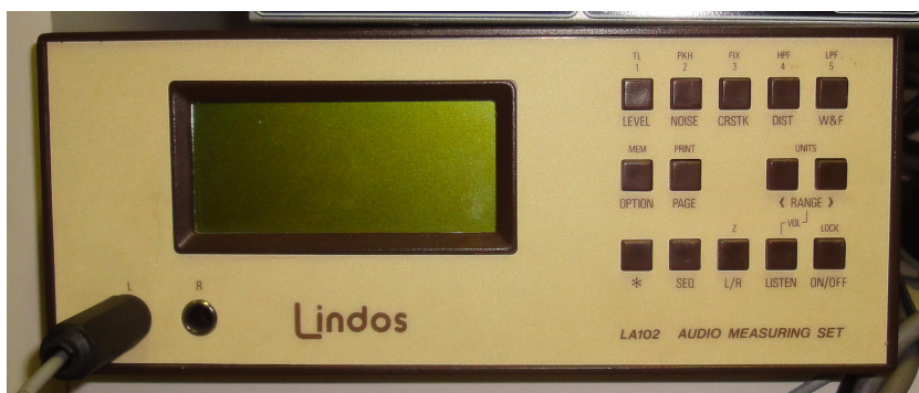
Obr D7: Audio analyzátor použitý pro generování TTL signálu
