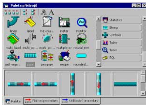
Obr. 44 – Paleta virtuálních přístrojů v systému Control Web. Přístroje je možno pomocí myši z palety přístrojů rozmístit do vytvářené aplikace a napojovat na vstupní či výstupní kanály. Tímto způsobem lze jednoduše naprogramovat řídicí panel technologického zařízení či interaktivní grafické uživatelské rozhraní simulátoru.
