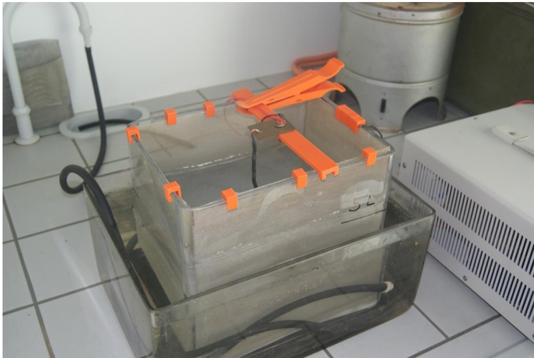
Obrázek 12 Sestava pracovní vany s elektrolytem pro technologii PEO
