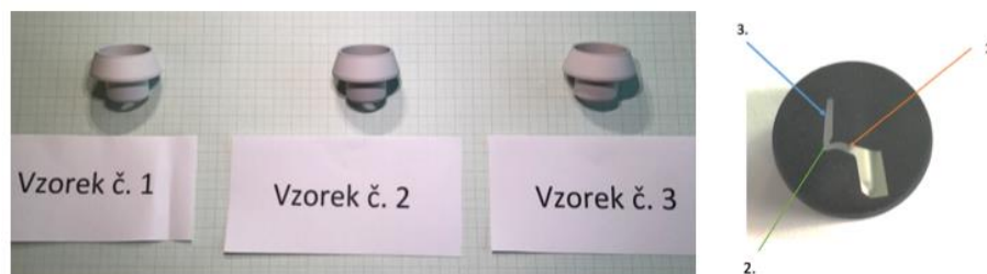
Obrázek 46: První sady vzorků s PEO povrchovou úpravou a sledované body vrstvy
