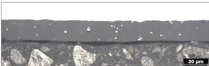
Obrázek 18: Optická mikroskopie tvrdé (funkční) anodické oxidace
