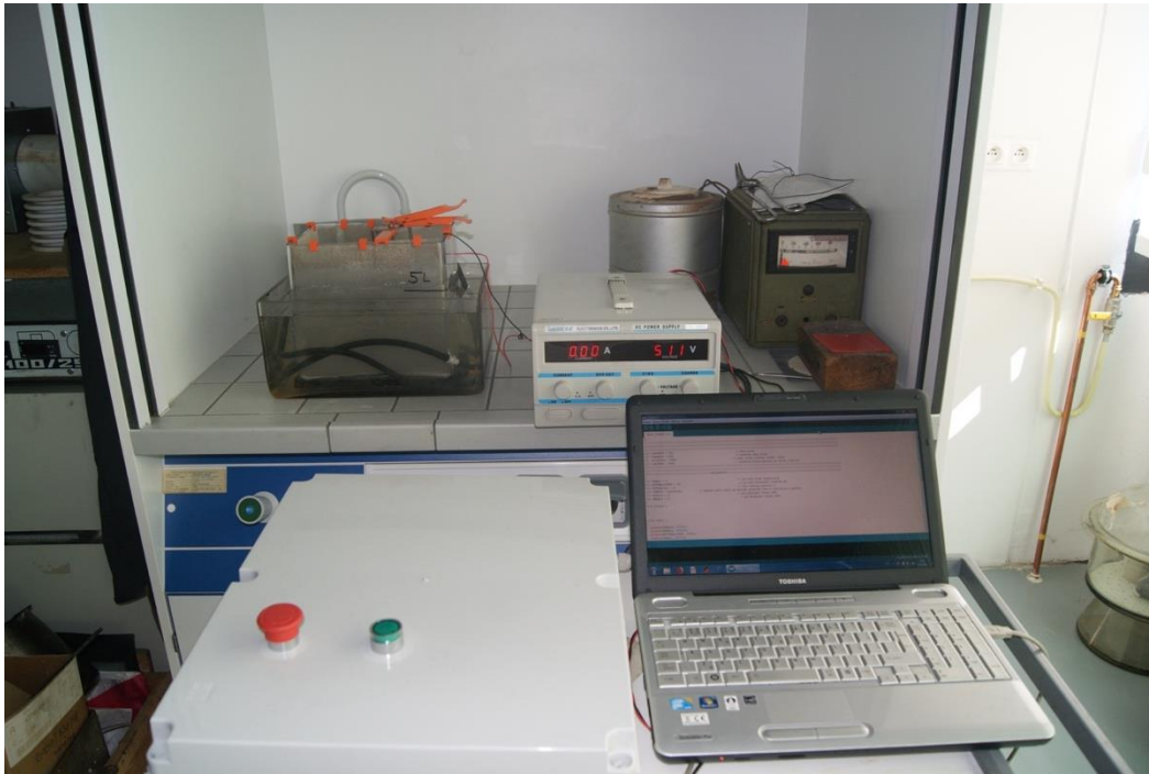
Obrázek 11 Sestava laboratorního pracoviště pro tvorbu vrstev PEO
