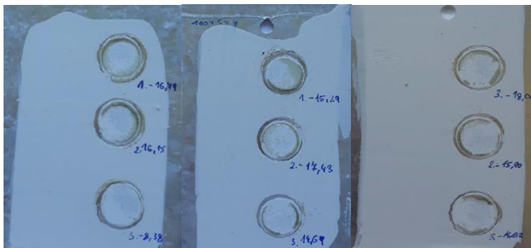
Obr.4: Vlevo a uprostřed: výsledky odtrhových zkoušek, chemický prostředek Coatosil MP200, dosaženo odtrhových napětí až 17 MPa, kohezní lom v nátěru (100%B), NS S 2318, vpravo: Modifikované parametry lázně – výsledky odtrhových zkoušek s odtrhovým napětím nad 18 MPa, kohezní lom v NS
