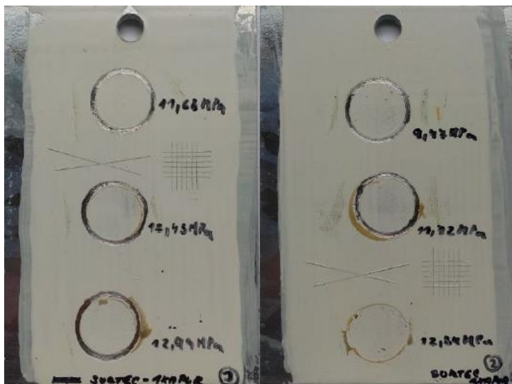
Obr.2: Výsledky odtrhových zkoušek – SurTec 678 a nátěrový systém U 2218, odtrhové napětí okolo 13 MPa
