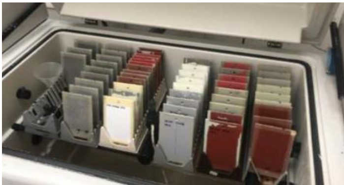
Obr. 5: Umístění zkušebních vzorků v solné komoře
