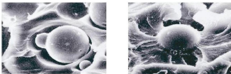
Obr. 31: Rozdíl v adhezi částice pigmentu nátěrové hmoty bez úpravy a upraveného silany [2].
