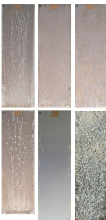
Obr. 26: Konverzní vrstva na slitině AA7075-T6 po 168 hodinách expozice v solné mlze a) postup 1, b) postup 2, c) postup 3, d) postup 4, e) konverzní vrstva chromanu (Alodine 1200S), f) slitina bez konverzní vrstvy [29]
