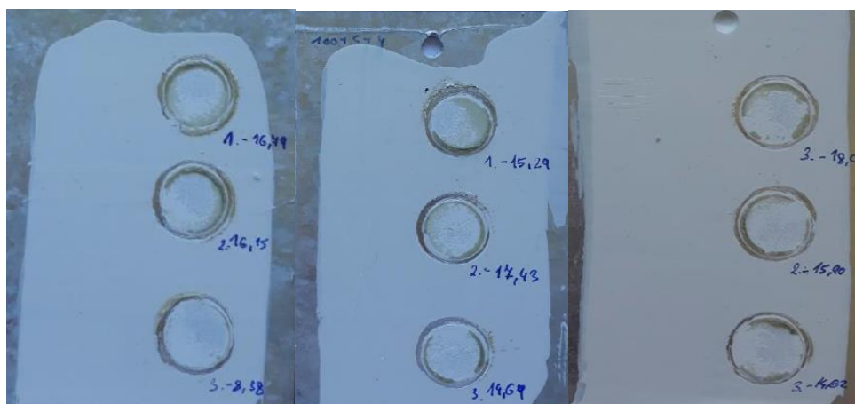
Obr. 37: Vlevo a uprostřed: výsledky odtrhových zkoušek, chemický prostředek Coatosil MP200, dosaženo odtrhových napětí až 17 MPa, kohezní lom v nátěru (100%B), NS S 2318, vpravo: Modifikované parametry lázně – výsledky odtrhových zkoušek s odtrhovým napětím nad 18 MPa, kohezní lom v NS
