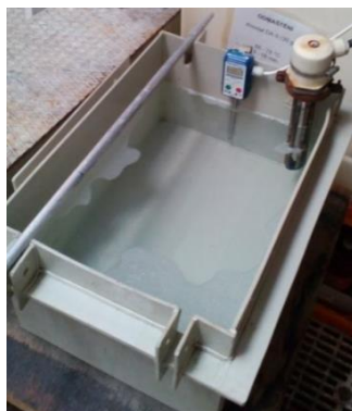
Obr. 33: Vytvořená lázeň pro odmašťování pomocí prostředku Simple Green (koncentrace 1:30)
