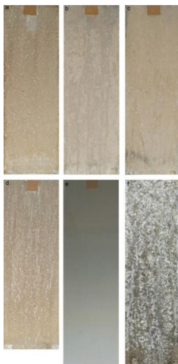
Obr. 25: Konverzní vrstva na slitině AA2024-T3 po 168 hodinách v solné mlze a) postup 1, b) postup 2, c) postup 3, d) postup 4, e) konverzní vrstva chromanu (Alodine 1200S), f) slitina bez konverzní vrstvy [29]
