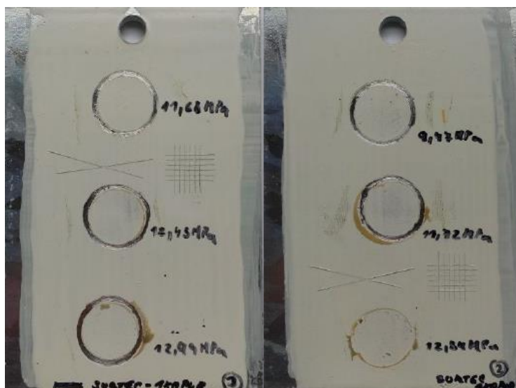
Obr. 35: Výsledky odtrhových zkoušek – SurTec 678 a nátěrový systém U 2218, odtrhové napětí okolo 13 MPa
