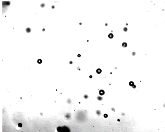
Obrázek 11.8 Snímek disperze voda-olej, Míchadlo RT 250 ot./min, 5. min. měření, 90 W LED čip, Kamera MKIII, Objektiv Sigma, Velikost snímané oblasti cca 15 x 12 mm.
