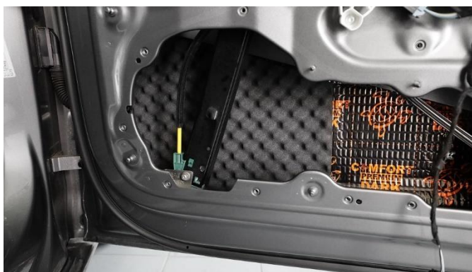
Obrázek 44 - odhlučnění dveří izolační pěnou [12]
