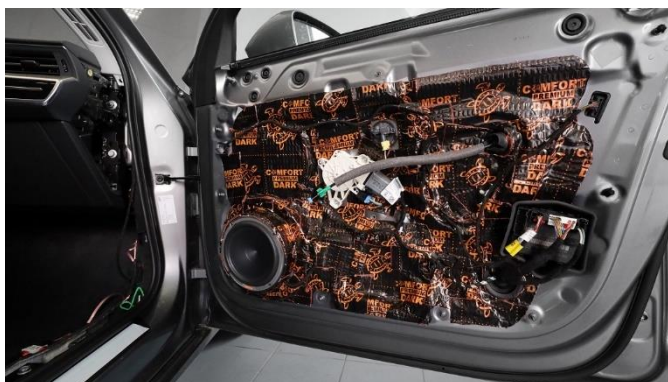
Obrázek 45 - odhlučnění dveří antivibračním materiálem [12]
