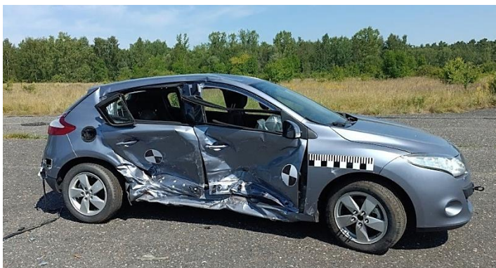
Obrázek 36 - Renault Megane po bočním nárazu s jiným vozidlem [crash test léto 2023]
