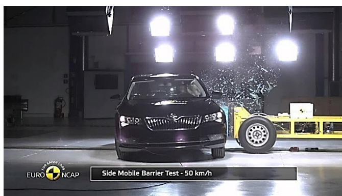
Obrázek 35 – kontakt bariéry s bokem vozidla [10]
