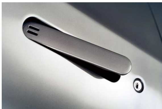
Obrázek 28 - klika tlačného typu [24]
