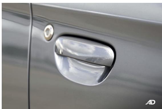
Obrázek 25 - klika typu klapka [24]
