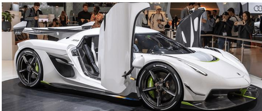
Obrázek 6 - Dveře typu "Dihedral Synchro-helix" [3]
