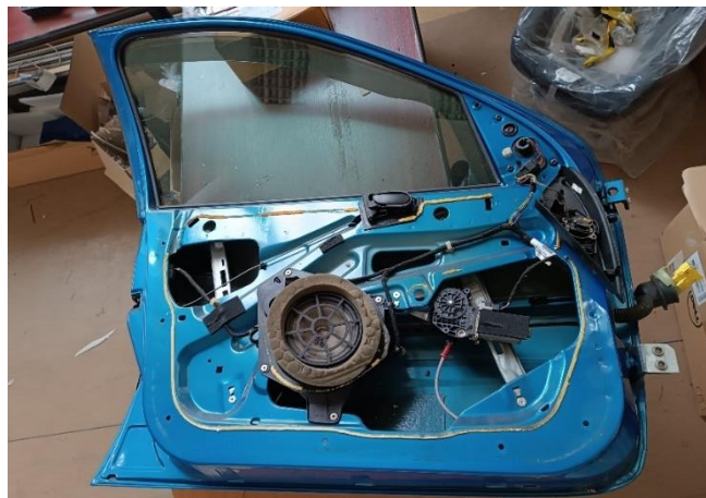
Obrázek 57 - dveře Peugeot 206 ve fázi rozebírání
