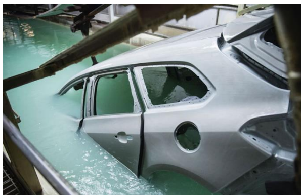
Obrázek 37 – Ponoření karoserie vozidla do zinkové lázně [21]
