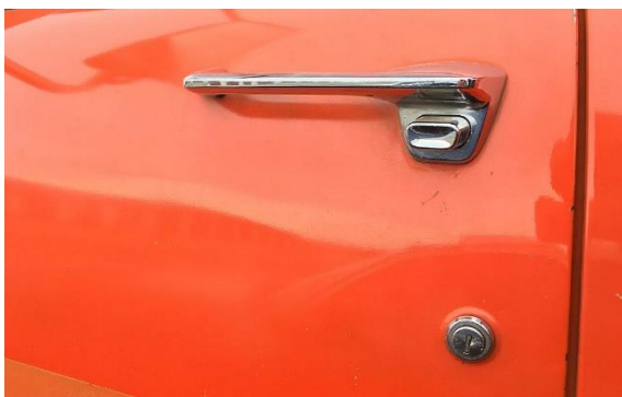
Obrázek 26 - klika tlačítkového typu [24]
