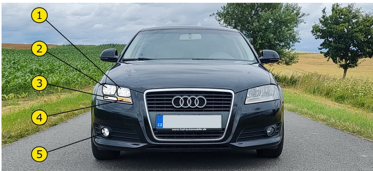
Obrázek 20: Popis předních světlometů Audi A3 (1 – dálkový světlomet, 2 – potkávací světlomet, 3 – denní/obrysová světla, 4 – směrový světlomet, 5 – mlhový světlomet), foto: autor
