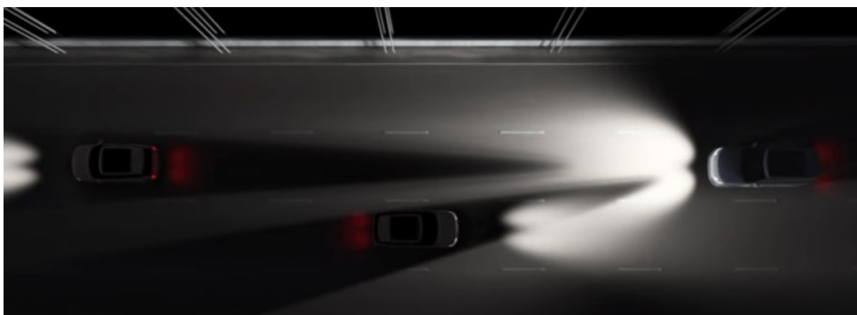
Obrázek 16: Aktivní stínování systému Matrix LED, [45]
