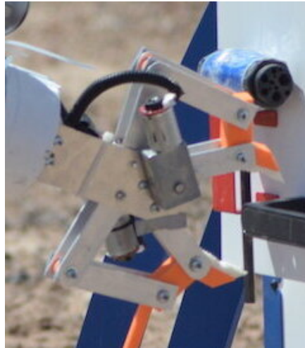
Obrázek 3.4: Dvouprstý gripper s dvěma články roveru Sandstorm. [26]
