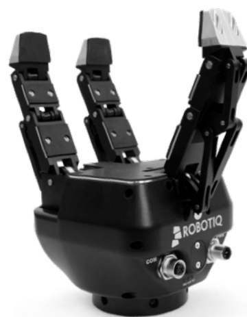
Obrázek 3.8: Tříprstý adaptivní gripper Robotiq. [33]
