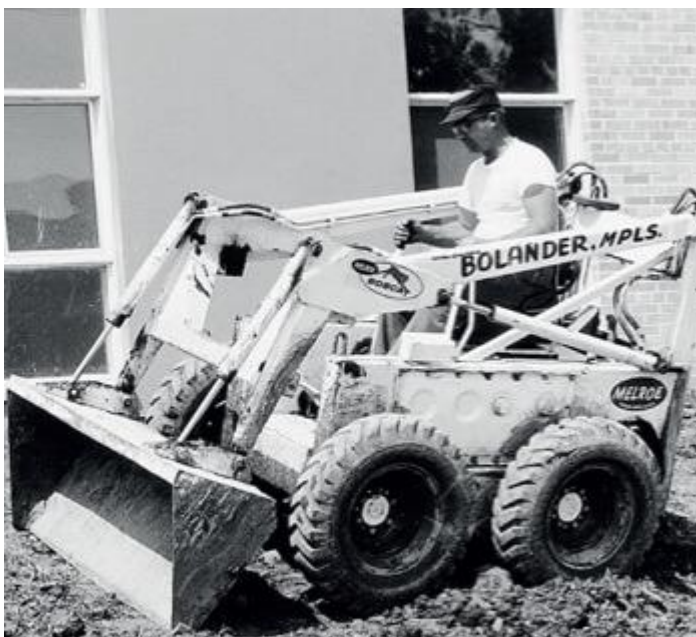
Obrázek 1: První smykem řízený nakladač Melroe Bobcat [1]
