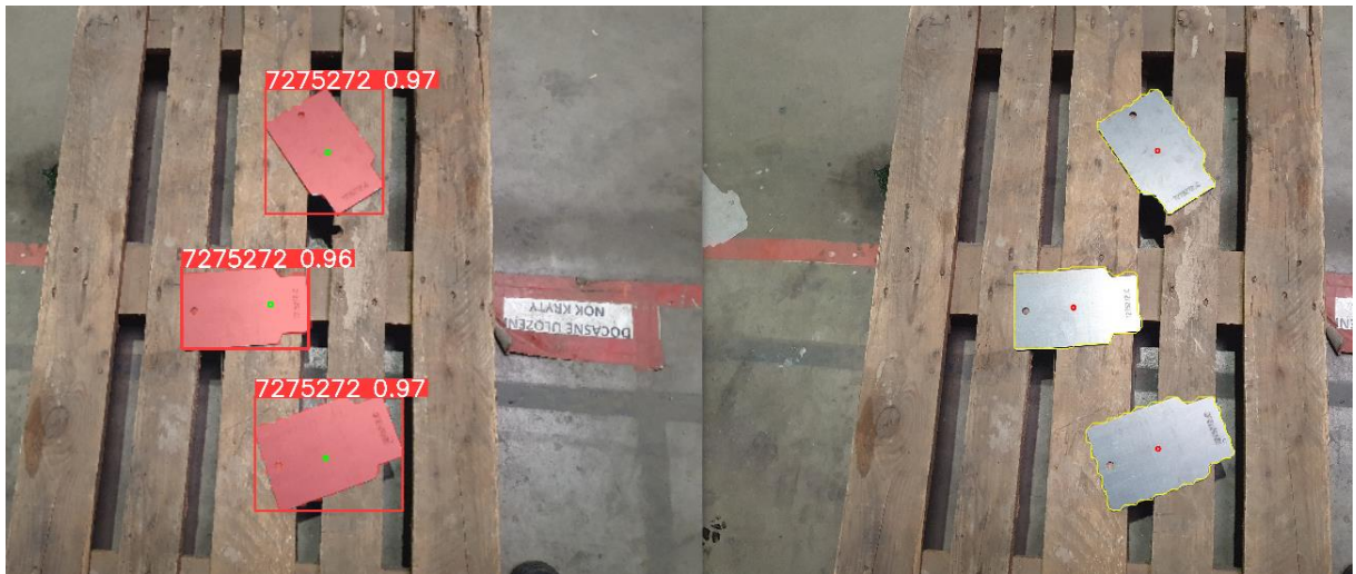
Obrázek 3: Porovnání dvou metod pro výpočet těžiště dílu – v levé části je těžiště vypočteno knihovnou NumPy a vyznačeno zelenou tečkou, na pravém obrázku je zobrazen výpočet knihovnou Shapely červenou tečkou
