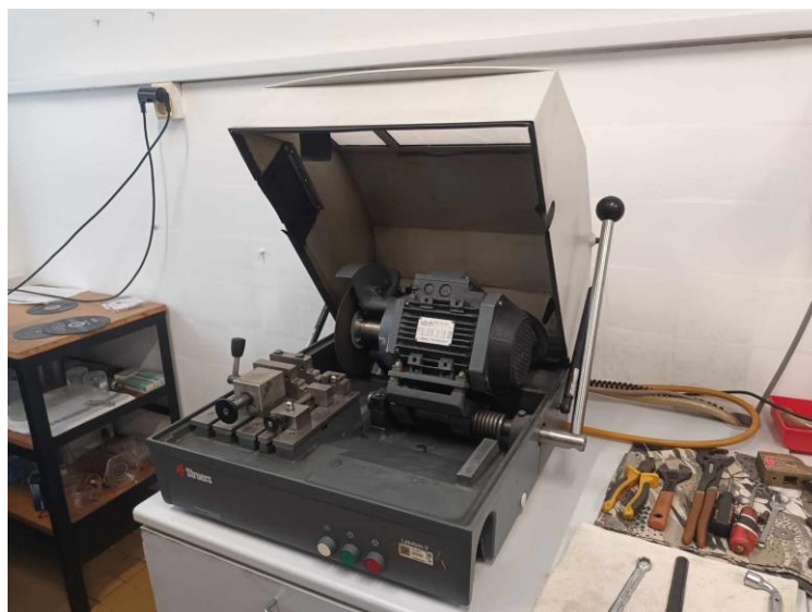
Obr. 26 – Laboratorní pila Labotom-3
