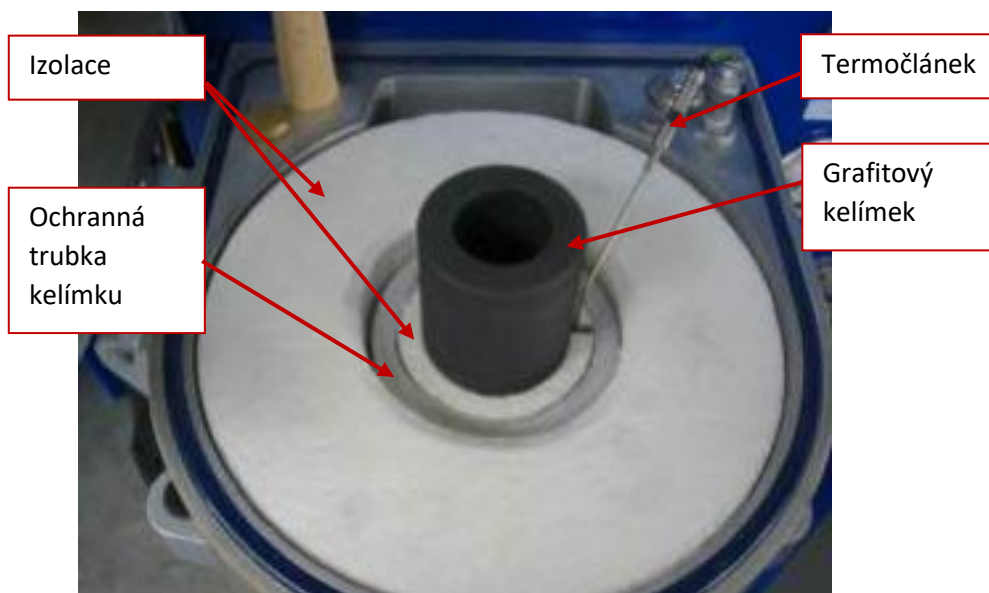
Obr. 33 – Ukázka otevřené pracovní komory (66)
