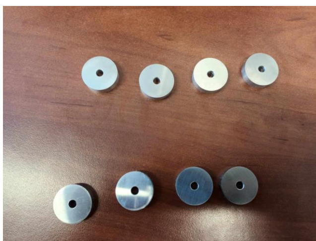
Obr. 29 – Vzorky s vyvrtaným otvorem (horní řada hliníková slitina, spodní ocel)
