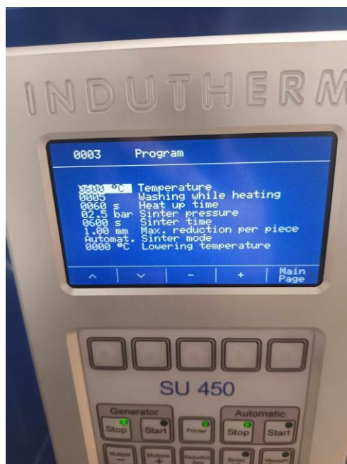
Obr. 35 – Nastavení programu pro teplotu 600 °C, čas svařování 600 s a tlak 2,5 baru
