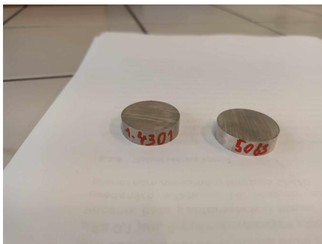
Obr. 27 – Nařezané vzorky (o tloušťce 7 mm)
