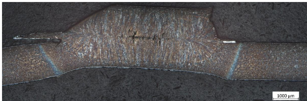
Obrázek 10 Mikrostruktura po bodovém odporovém svařování se staženinou uprostřed oceli 22MnB5
