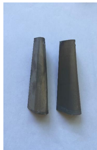
Obr. 28: Vzorek 1A – zinkový povlak s měděnými částicemi
