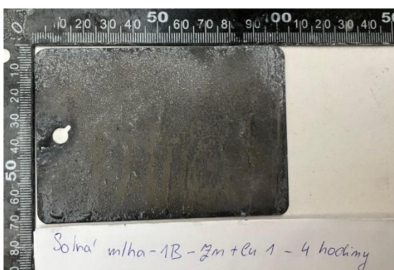
Solna' mlha - 1B - Zn+Cu 1 - 4 hodiny Obr. 78: Zinkový povlak s měděnými částicemi - 4 hodin
