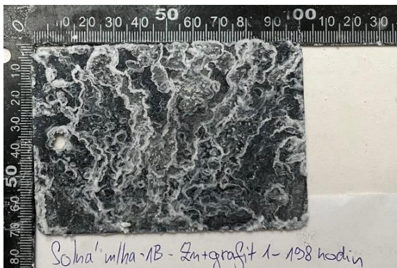
Solna mlha - 1B - Zn+grafit 1 - 198 hodin Obr. 71: Zinkový povlak s grafitovými částicemi – 198 hodin
