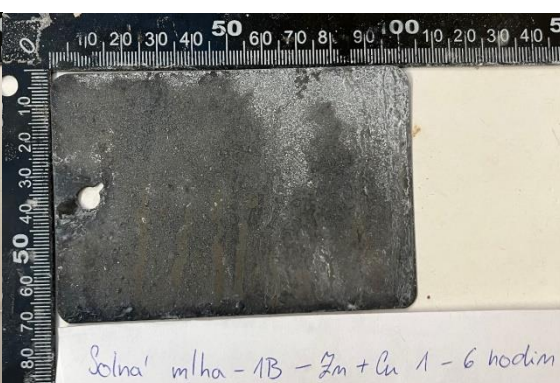
Solna' mlha - 1B - Zn+Cu 1 - 6 hodin Obr. 79: Zinkový povlak s měděnými částicemi - 6 hodin
