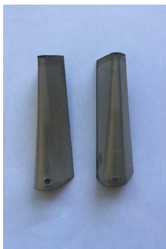
Obr. 27: Vzorek 1A – zinkový povlak s grafitovými částicemi
