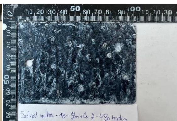
Obr. 151: Zinkový povlak s měděnými částicemi – 480 hodin (vlevo – vzorek před umytím vodou, vpravo – vzorek po umytím vodou)
