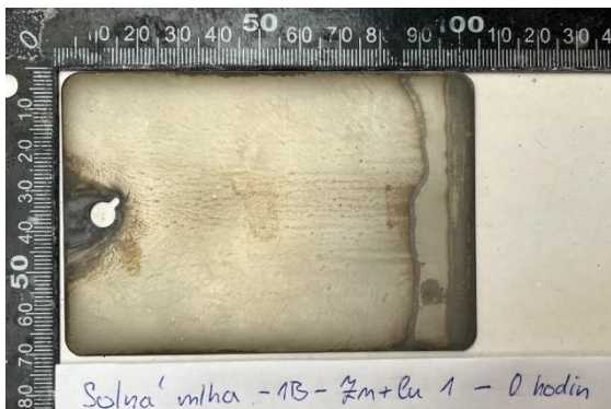
Solna' mlha - 1B - Zn+Cu 1 - 0 hodin Obr. 76: Zinkový povlak s měděnými částicemi - 0 hodin
