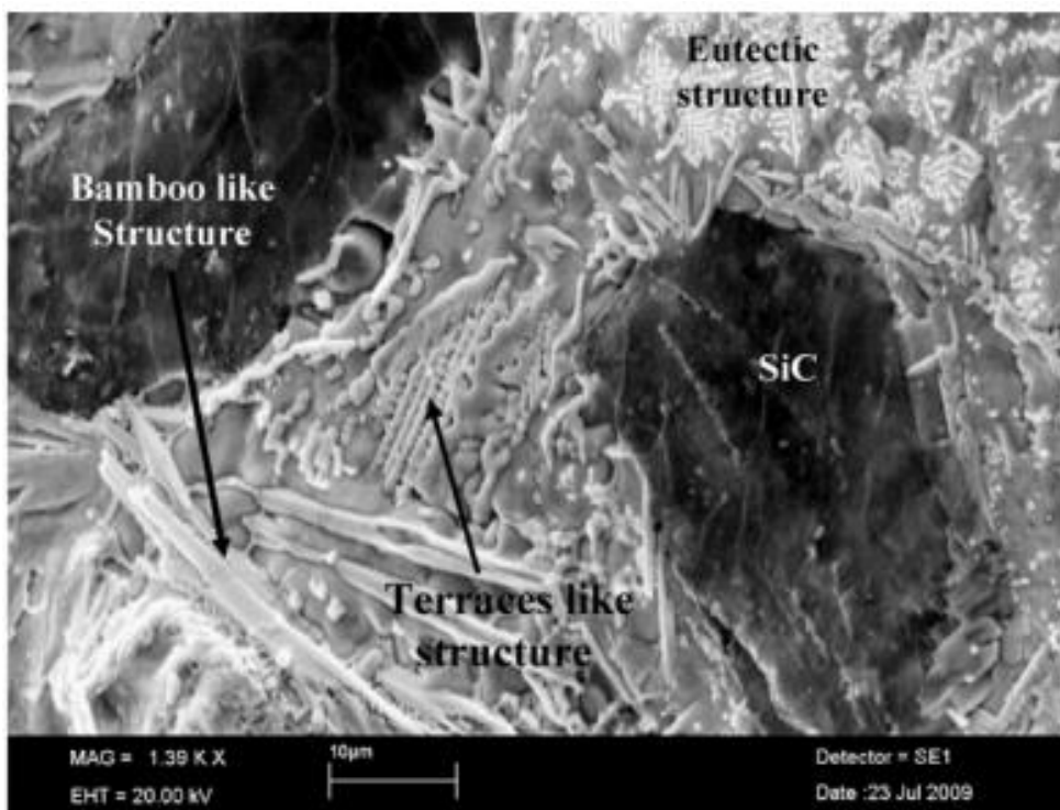
Obrázek 9 Růst pinzetových a eutektické fázi (SEM, 1390x)[27]
