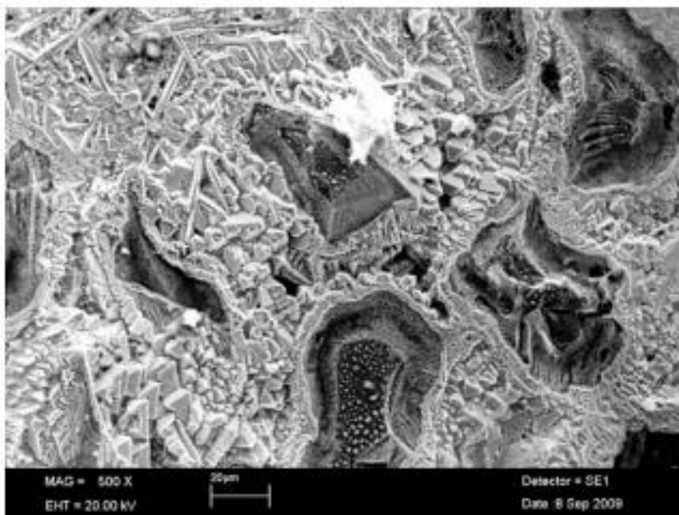
Obrázek 8 Růst pyramidových struktur při tavení EB (SEM, 500x)[27]
