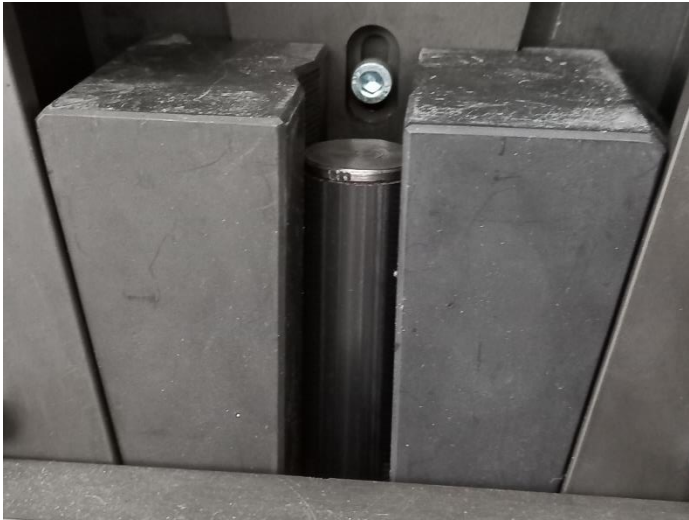
Obrázek 52: Způsob upnutí trubky v trhacím stroji
