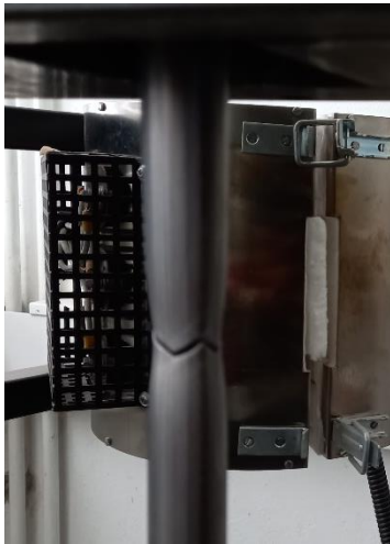
Obrázek 58: Přetržená trubka z tahové zkoušky
