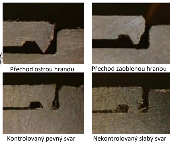
Obrázek 7: Vliv tvaru spoje na výsledný svar UT svařování [19]
