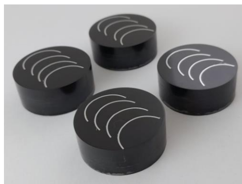
Obrázek 51: Zalisované vzorky v pryskyřici - Vzorky připravené pro metalografii a měření tvrdosti
