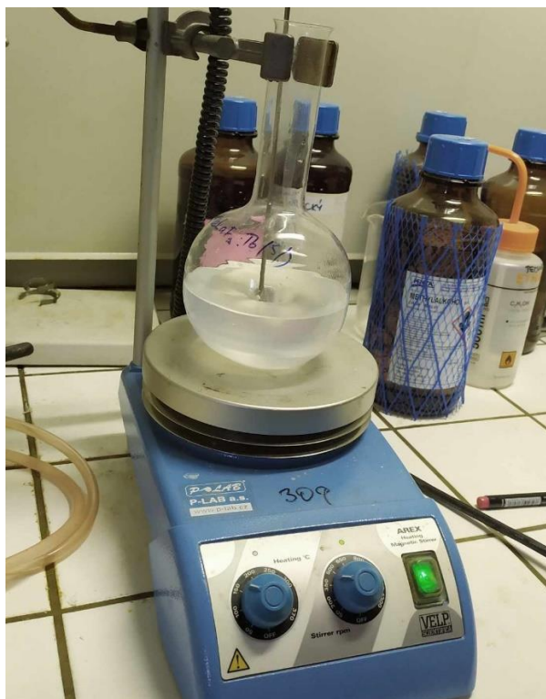
Obr. 18: Zahřívání směsi dusičnanů a fluoridu amonného v EGME na magnetické míchačce
