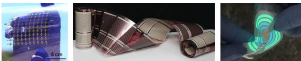
Obr. 7: Ukázky využití vytištěné elektroniky (zleva: pole tenkých tranzistorů, role hlubokotiskových inverzních OPV modulů, vícebarevný elektroluminiscenční displej), převzato z [27]
