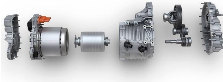
Obrázek 7: VW e-Golf - Rozložené hnací ústrojí [11]
