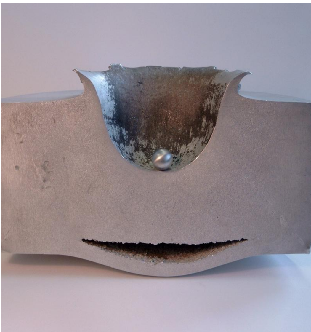
Obrázek 5.4: Náraz hliníkového projektilu o průměru 1,2 cm a rychlosti 6,8 \text{ km} \cdot \text{s}^{-1} do hliníkového kvádru s tloušťkou 18 cm [82] [83].
