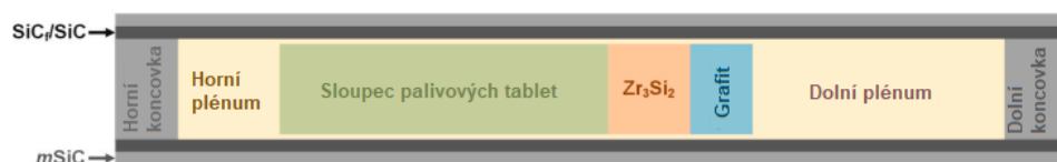
Obr. 1.8: Schéma palivového proutku reaktoru FMR [21].
