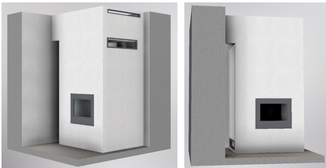
Obr. 4-9 Teplovzdušný krb s konvekčními otvory v místnosti
