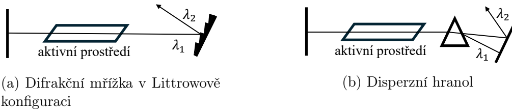
Obr. 1.2: Konfigurace pro ladění vlnové délky laseru. Upraveno z [2].
