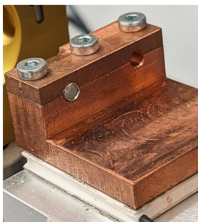
Obr. 6: Obrázek s krystalem využívaným pro laserový systém Tm:YLF. Krystal je umístěn v měděném držáku, který umožňuje chlazení.
