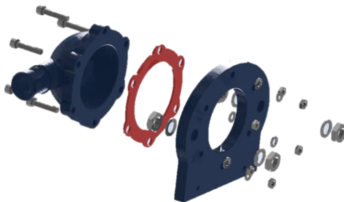
Obrázek 27 Rozpad konstrukce komory
