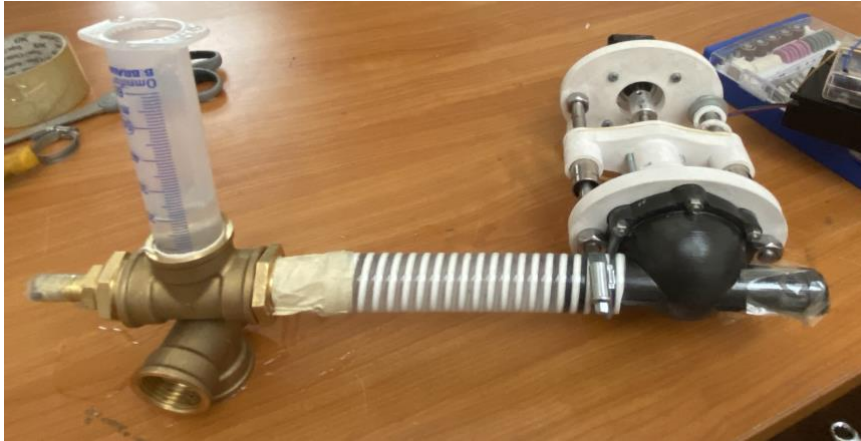
Obrázek 32 Mokry test pulzatičního čerpadla
