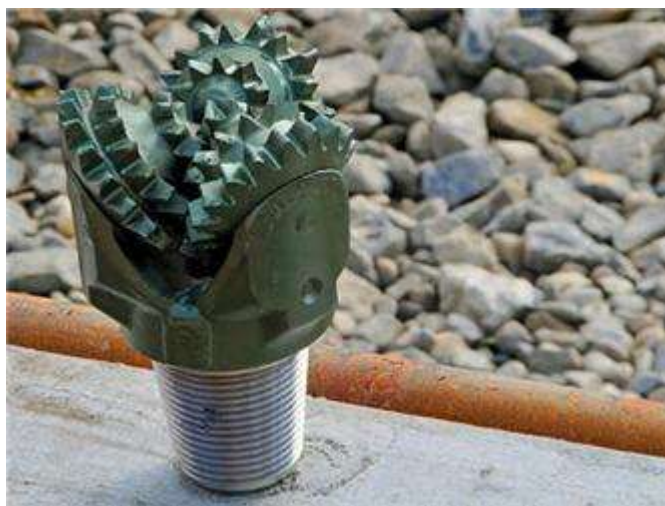
Obr. 2.3: Vrták používaný při hloubení zkušebních vrtů 35
