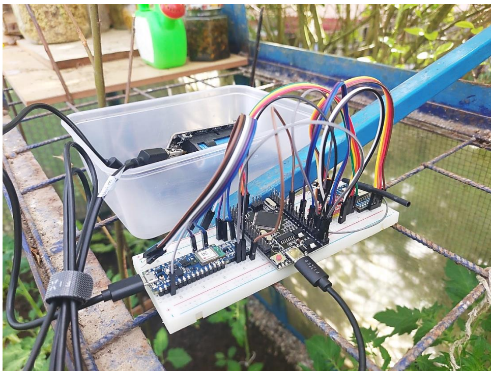
Obr. 4.36: Měřicí soustava teploty a vlhkosti v prostorech skleníku
