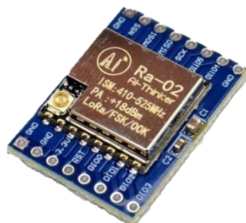
Obr. 3.2: Bezdrátový komunikační modul 433 MHz SX1278 LoRa RA-02 [53]
